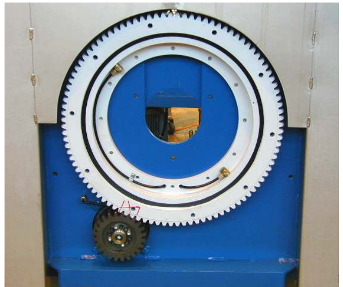
Motorhalteplatte mit Zahnradantrieb und Zahnkranz
