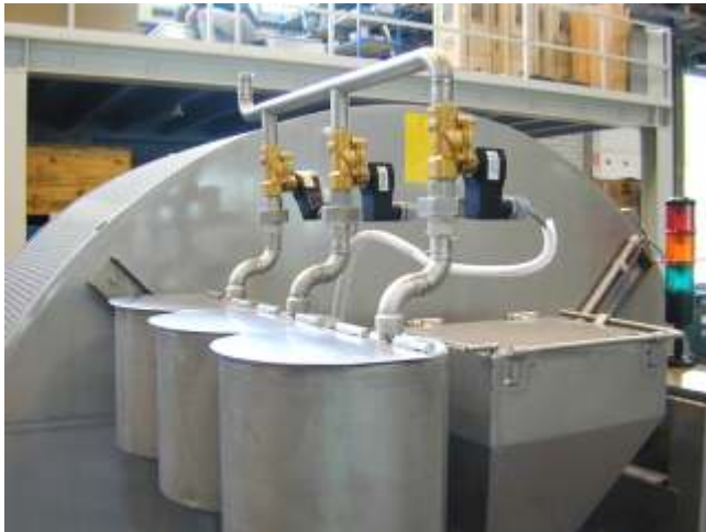
Automatische Dosierbehälter mit Spüleinrichtung
